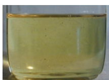
Hydraulikolie med vand på bunden
