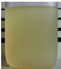
Diesel kølet ned til under C.P.
