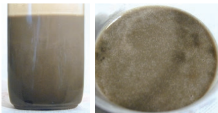
Motorolie med højt vandindhold, klumpet og uhomogen
